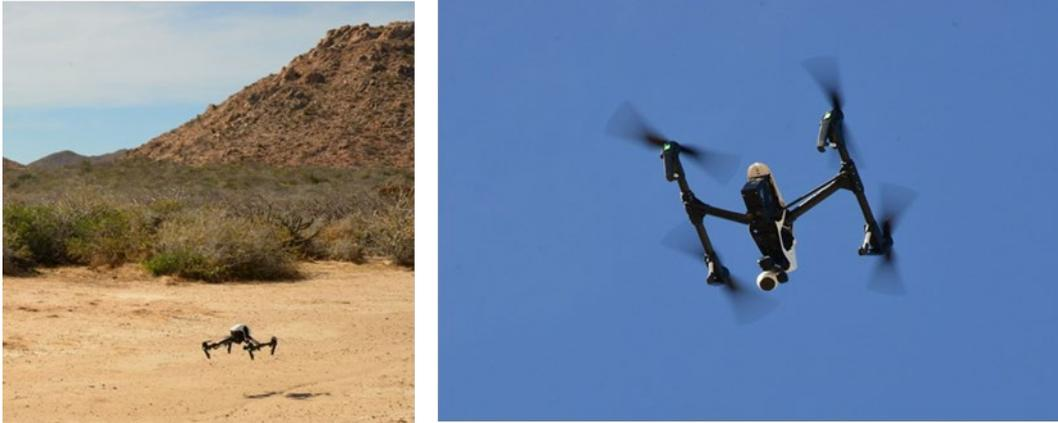
**Figura 2.** Izquierda: despegue de un VANT cuadricóptero Inspire 1. Derecha: Inspire 1 en el aire llevando a cabo una misión de vuelo autónoma.
